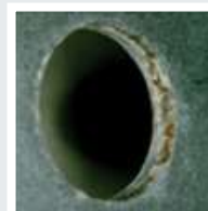
6 mois (acier galvanisé) 30-40% de rouille rouge 60% de rouille blanche
